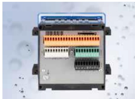
Rückseite des Bürkert MultiCELL 8619 Controllers mit SD-Kartenslot, Mainboard (orange), Signaleingangskarte pH/ORP (weiß), Signaleingangskarte Leitfähigkeit (grün) und Signalausgangskarte (schwarz). Die drei noch freien Steckplätze sind durch die Metallplatte geschützt
