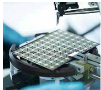
Für die elektrischen Anschlüsse befindet sich die Testplatte unter dem manuellen Bonder für Deep Access Wedge.
