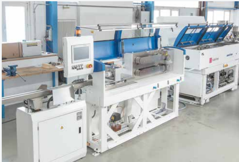
Extrusionsanlage BREYER TopLine, ausgestattet mit Fluidtechnik von Bürkert
