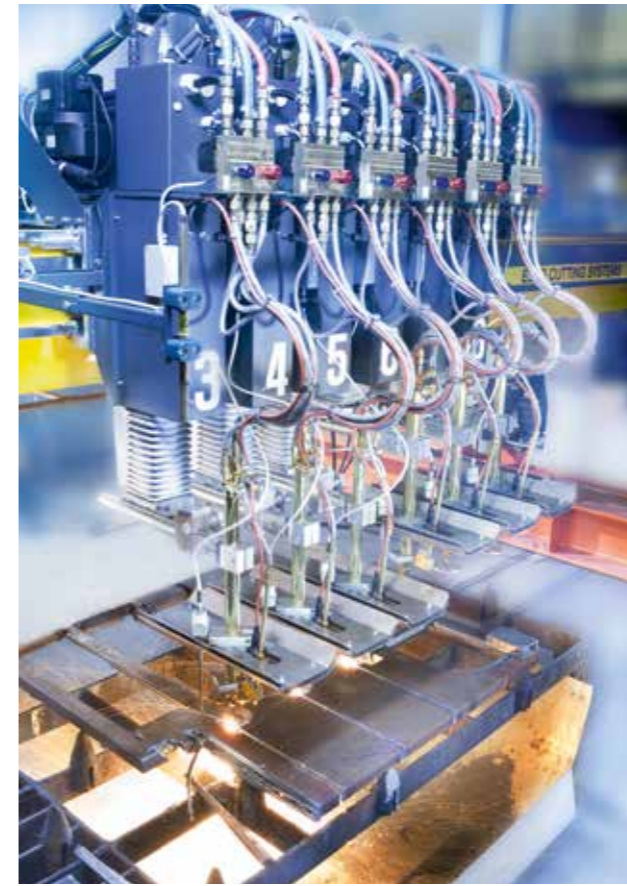
Gas-Brennschneidmaschine mit automatisierter Systemlösung
