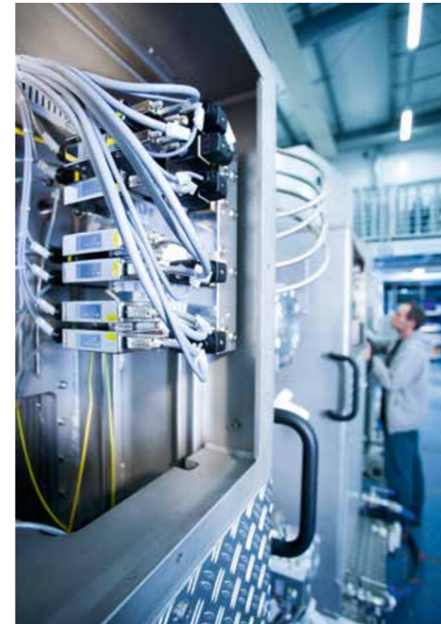
Beschichtungsanlage mit vollautomatisierter Gassteuerung
