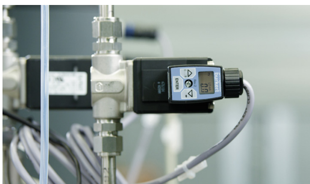
Elektromagnetische Proportionalventile regeln den Stackdruck
