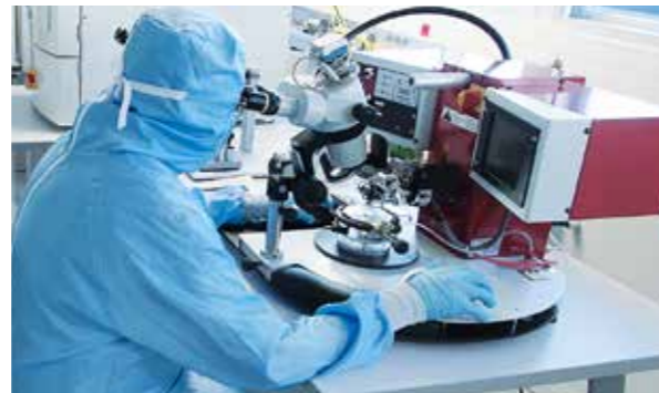
Die gesamte Produktion der Interdigitalwandler findet unter Reinraumbedingungen statt.
