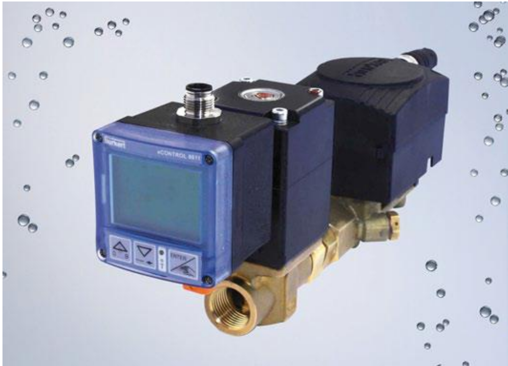
Abb. 2: Durchfluss-Regelsystem mit Proportionalventil Typ2835, Ultraschall Durchflusssensor Typ8081 und eCONTROL 8611 (Durchflussbereich 0,06 - 20 l/min)
